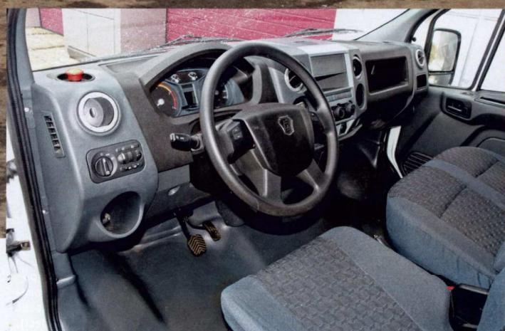
В кабине электро-Газели две педали вместо трех: коробки передач и сцепления здесь нет!
