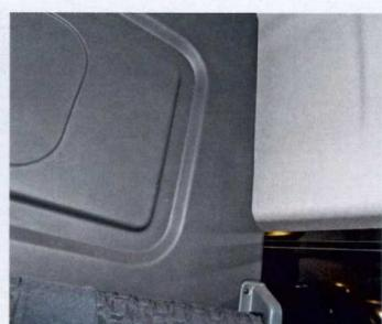
На ходу поскрипывал стык панели обшивки и перегородки грузового отсека
