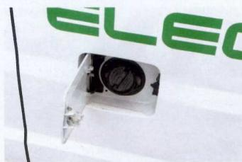
Топливный бак нужен электро-Газели для питания дизельных печек-автономок
