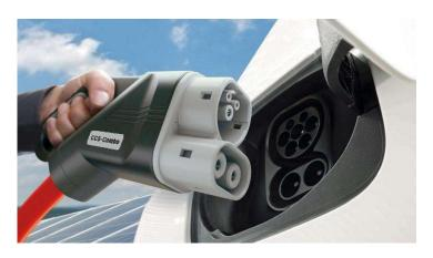
Combined Charging System (CCS) - пожалуй, одна из самых популярных в мире и наиболее перспективная технология для зарядки электрического транспорта, которая обеспечивает быструю зарядку электромобилей мощностями до 360 кВт. В то же время, с точки зрения инженерной реализации, это наиболее сложная технология, для понимания работы которой и имплементации на практике требуется большое количество времени и инженерных ресурсов.
